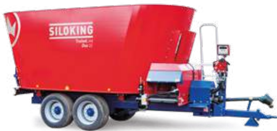
Il SILOKING TrailedLine Classic Duo può anche essere dotato di un assale tandem per un carico elevato e lunghe distanze di guida.
