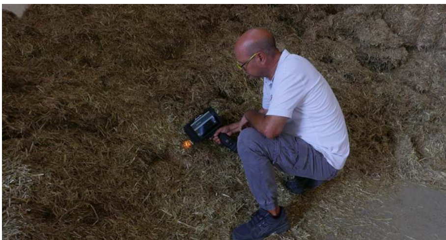
Fanin: Paolo Berzagi (dipartimento di Medicina animale, produzione e salute, Università di Padova) durante controllo del fieno con un dispositivo Nir portatile.
