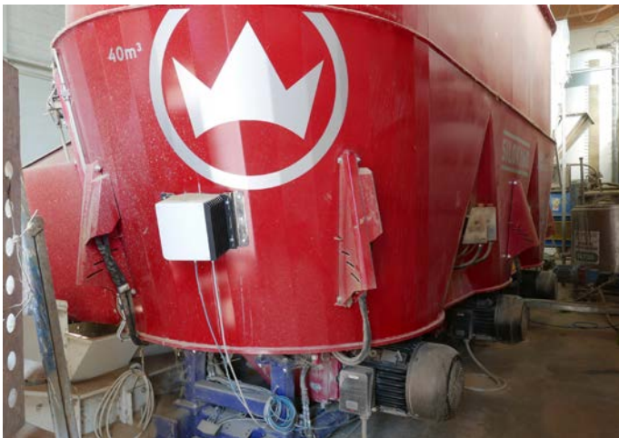
Fanin, in evidenza il dispositivo Nir applicato al miscelatore.
