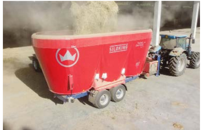
Azienda San Michele, sopra: due momenti del carico del fieno. A sinistra: l'azione di taglio e miscelazione dei foraggi da parte delle tre coclee. Il carro è un Siloking Trailed Line tre coclee da 32 mc
