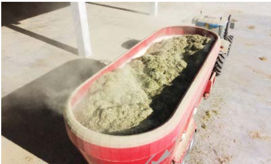
Azienda San Michele, sopra: due momenti del carico del fieno. A sinistra: l'azione di taglio e miscelazione dei foraggi da parte delle tre coclee. Il carro è un Siloking Trailed Line tre coclee da 32 mc
